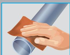
Assembler le tube et le raccord puis marquer la zone du tube à encoller à l'aide d'un crayon gras. Si nécessaire, penser à marquer l'alignement à respecter lors du collage. A l'aide d'un papier de verre fin, dépolir les parties à encoller sur le tube à l'intérieur du raccord. Puis essuyer à l'aide d'un chiffon propre.
