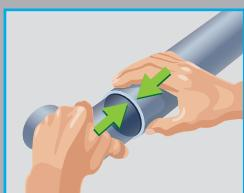
Encoller la partie du tube précédemment définie et l'intérieur du raccord puis emboîter sans torsion les deux parties. Retirer l'excès à l'aide d'un chiffon propre.
