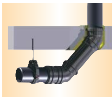
Traversée de plancher avec pied de chute long (hauteur de chute supérieure à 10 m)
